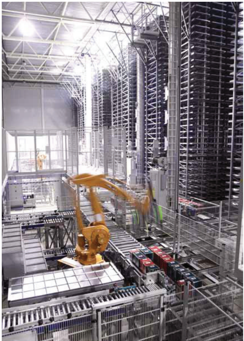
↑ Das 16-gassige automatische Aktenlager der Sberbank wird von Regalbediengeräten des Typs viaspeed XL versorgt.
